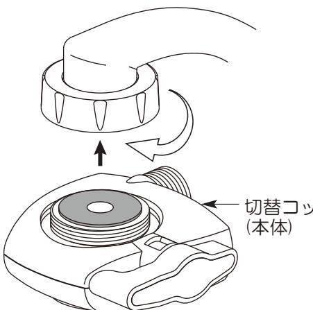
(3) 切替コック（本体）からキャップを外し、アダプターを切替コックのキャップに通して、蛇口の先端にアダプターをコイン等により取り付けます。
