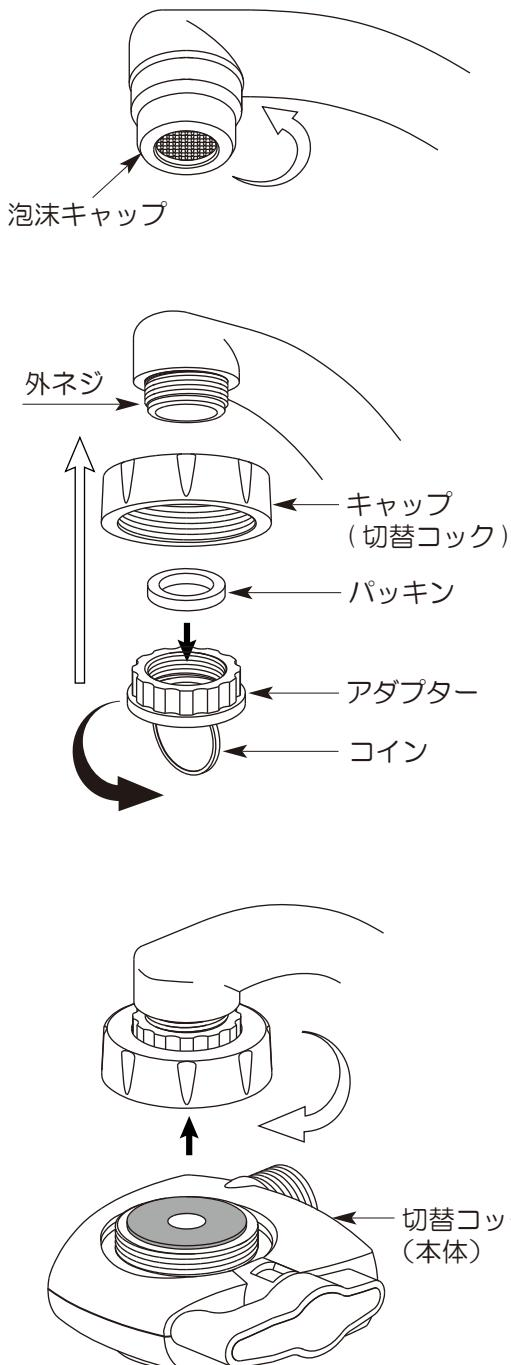
(1) 蛇口先端の泡沢キャップを手で回しながら外して下さい。
