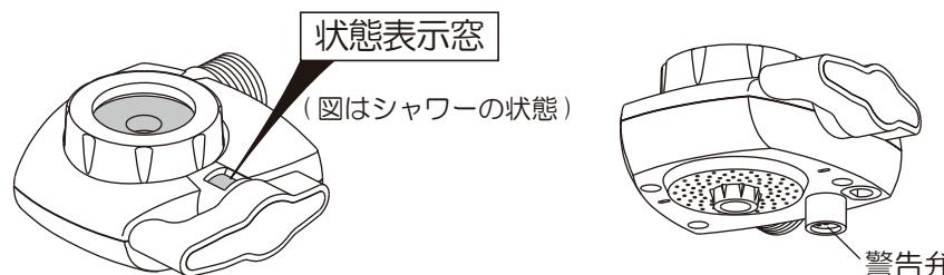
**ご注意** 一定量以上の圧力がかかると、水は警告弁から排水されます。その状態では絶対にご使用にならないで下さい。必ず水圧を弱めてからご使用下さい。
