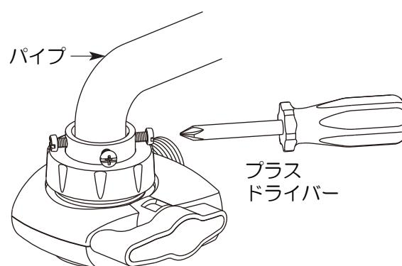
(1) 蛇口の先端が、ストレートタイプに取り付けできます。
