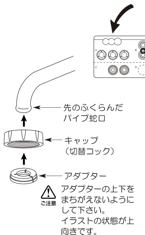
(2) 切替コック（本体）からキャップを外して蛇口の先端にキャップを通します。
