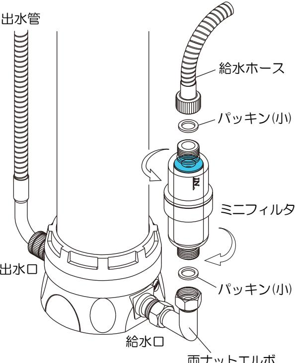
(4) 両ナットエルボにミニフィルタを接続し、給水ホースを接続して下さい。
