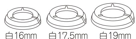
(4) 切替コック本体を水平にして、キャップを回しながら、手で締め付けて下さい。
