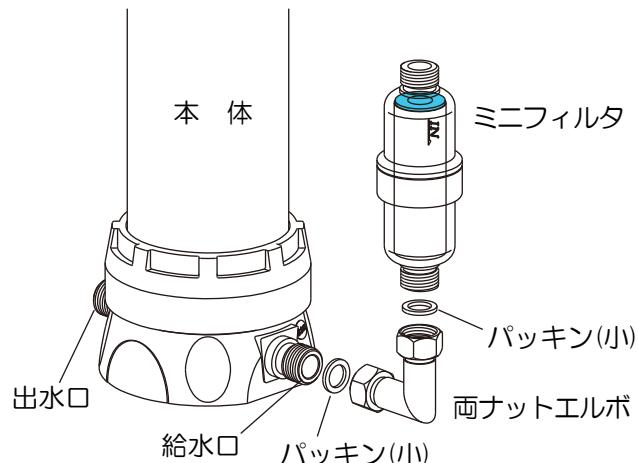
手で締めても両ナットエルボが倒れる場合は、スパナなどの工具で、両ナットエルボが倒れない程度まで締めて下さい。
