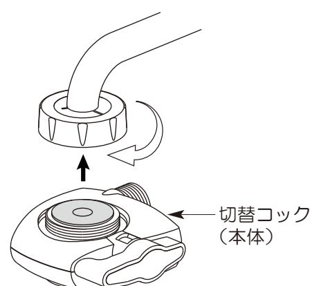
(3) サイズの合った丸型パイプアダプターを蛇口の先端に差し込んで下さい。
